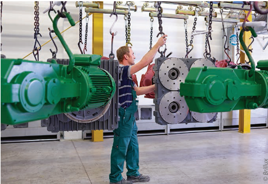
Die Farbtöne des Decklacks werden meist vom Endkunden vorgegeben. Dadurch kommt es im Produktionsprozess zu häufigen Farbwechseln.
