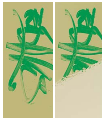
Beschichtungsmaterial ohne permanente Antigrffiti-Wirkung – nach der Reinigung verändert sich das optische Erscheinungsbild.
