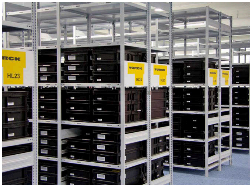
Der gesamte Lagerbereich der Firma Turck wurde als EPA-Schutzzone eingerichtet. Die Regalsysteme sind mit einem ableitfähigen Hybrid-Pulverlack beschichtet.
