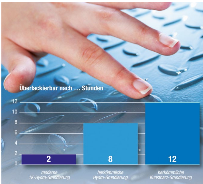
Bild 1: Trocknungsdauer verschiedener Lacksysteme im Vergleich
