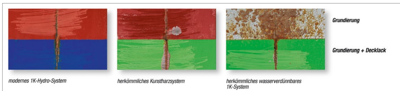
Bild 4: 240-h-Salzsprühstest nach DIN EN ISO 9227 auf entfettetem Stahlblech
