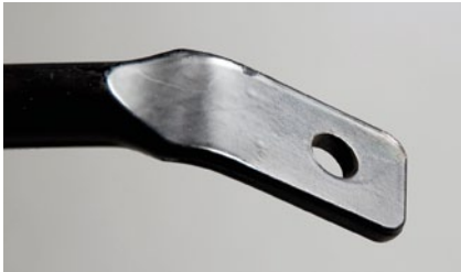
Bild 6: Nach 4 Zyklen VDA-Wechseltest 621-415 zeigen sich keine Ansätze von Korrosion auf der Fläche sowie im Kantenbereich
