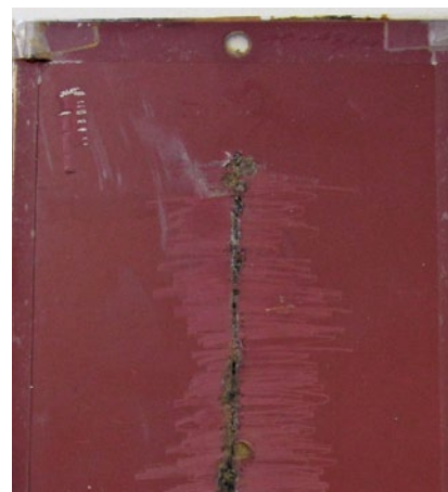
Bild 5: 1K-Acrylat-Grundierung nach 750 Stunden SST auf entfettetem Stahlblech
