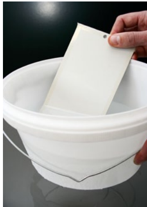
Bild 7: Überprüfung der Frühwasserbeständigkeit
